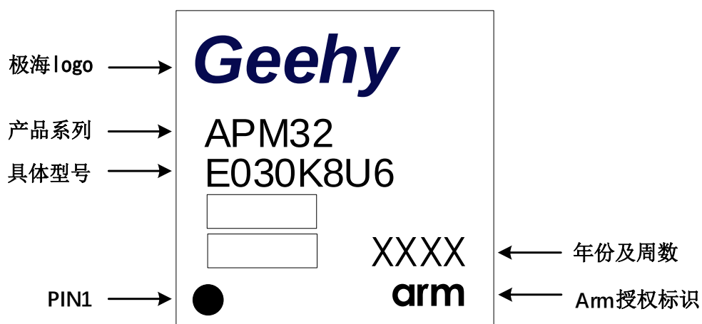
图 34 QFN32 - 32 引脚，5 x 5mm 封装标识
