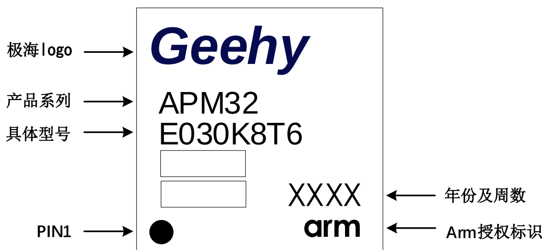
图 31 LQFP32 - 32 引脚，9 x 9mm 封装标识
