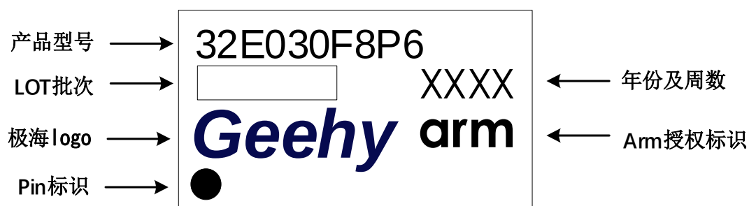
图 40 TSSOP20 – 20 引脚，4.4 x 6.5mm 封装标识
